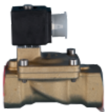
Электромагнитный клапан н.о. DN15, 220 В~
